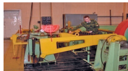
Стенд для определения характеристик гусениц
