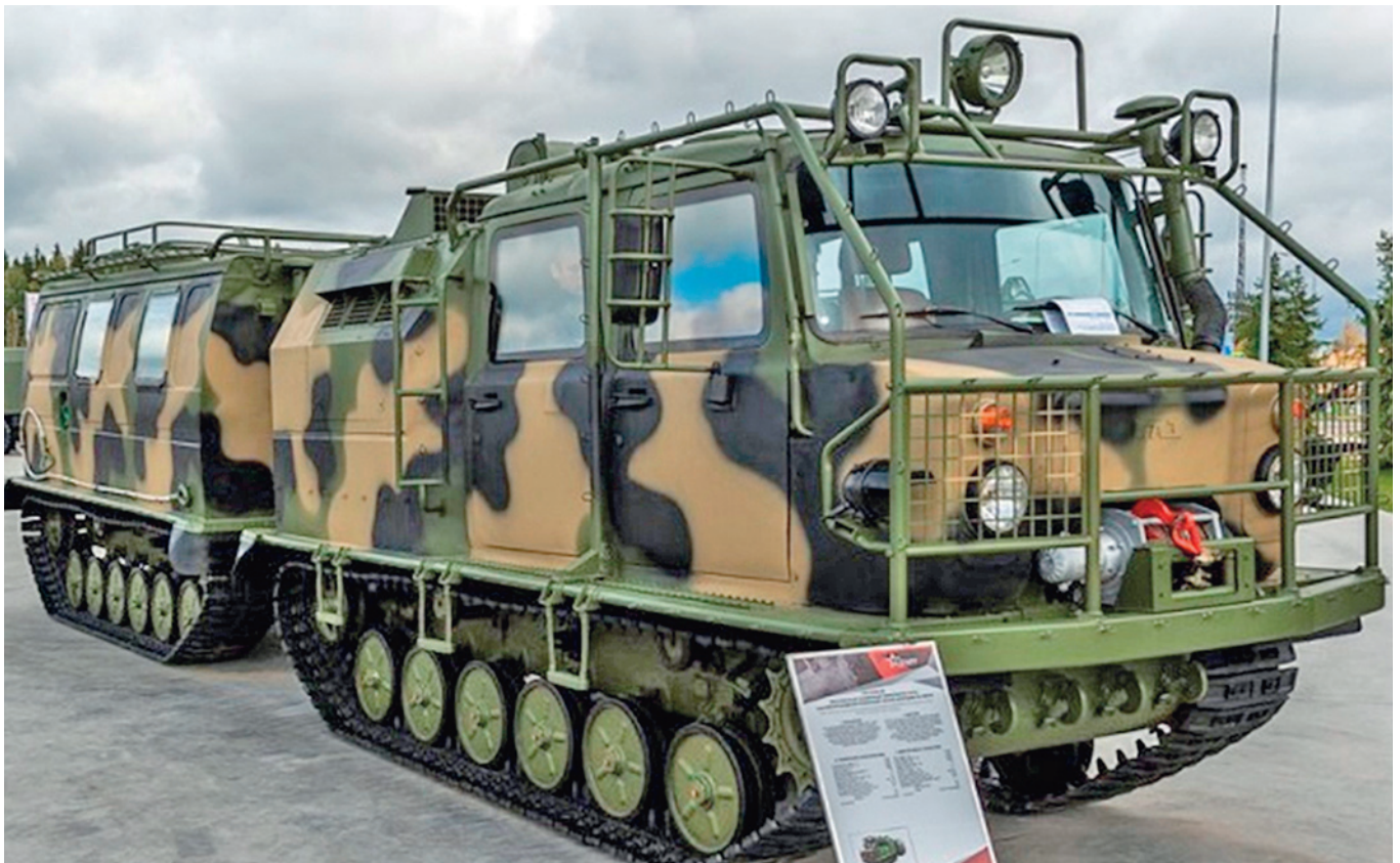
Двухвальный гусеничный транспортер-тягач ГАЗ-3344-20
